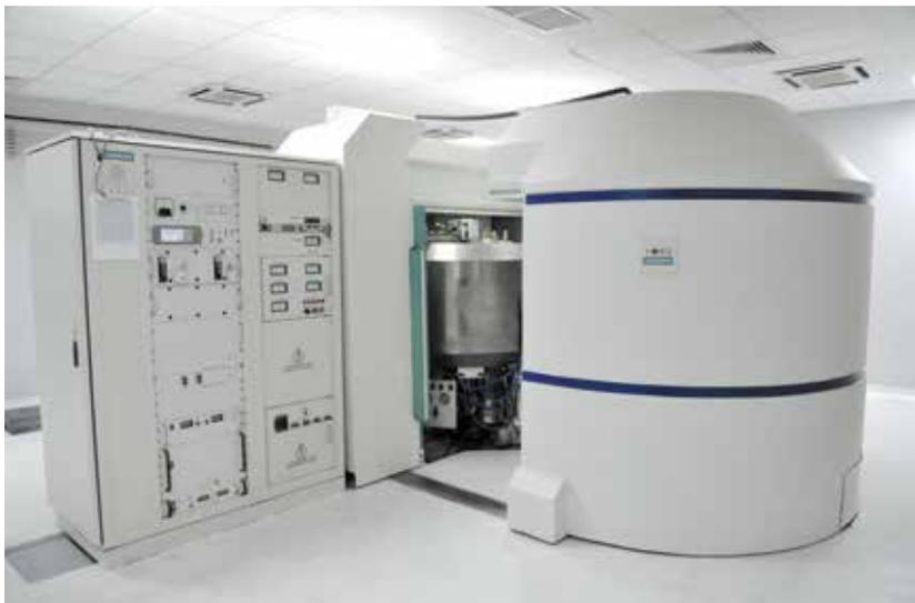
*Имеется собственный циклотронно-радиохимический комплекс по производству радиофармпрепаратов для обеспечения работы блока радионуклидной диагностики*
