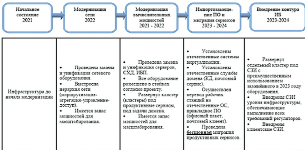
Рис. 2. Этапы проведения работ по формированию серверной и сетевой инфраструктуры. Используемые сокращения: ИБП – источник бесперебойного питания; КД – контроллер домена; ОС – оперативная система; ПО – программное обеспечение; СЗИ – средства защиты информации; СХД – система хранения данных
